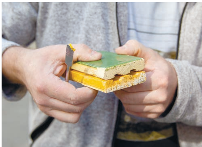
Сложив две керамические плитки таким образом, сквозные отверстия образуют «пяточек», за который эту плитку прозвали «кабанчиком»
