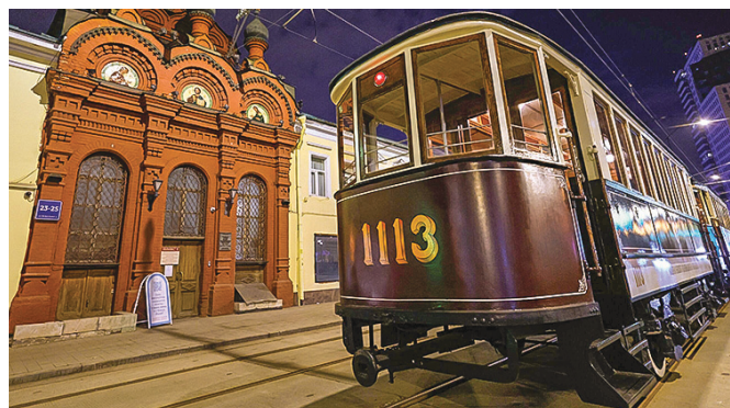
Этот прицепной вагон типа «Н» («Нюрнбергский») изготовлен на Мытищинском заводе в 1909 году
