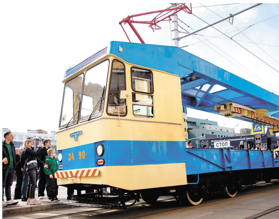
СВАРЗ РТ-3, «коренной москвич», выпущенный в 1984 году на Сокольническом вагоноремонтном заводе, предназначен для перевозки рельсов к местам строительства и ремонта трамвайных путей / ОЛЬГА КАРАСЁВА
