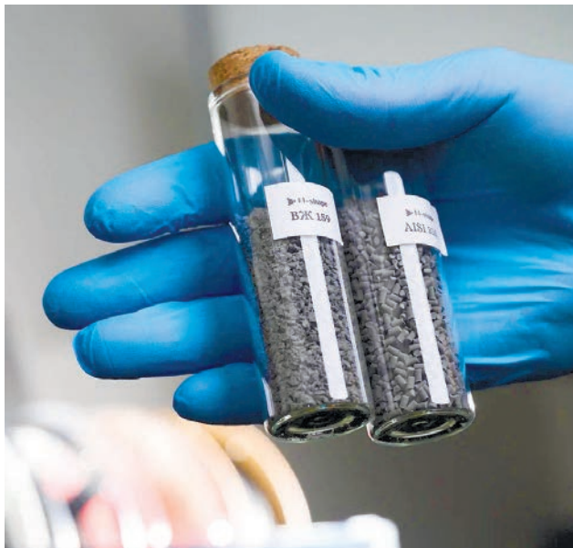
Гранулы похожи на пластиковые, но на самом деле с их помощью можно печатать металлом / ВСЕ ФОТО: ПРЕСС-СЛУЖБА ДИПП
